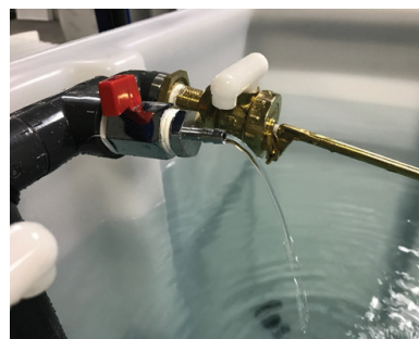
Instelling aangepast naar een snellere waterverversing voor een gestage waterstroom uit de stortklep voor waterverversing
