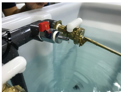
Fabrieksinstelling: water druppelt constant uit de handbediende stortklep voor waterverversing
